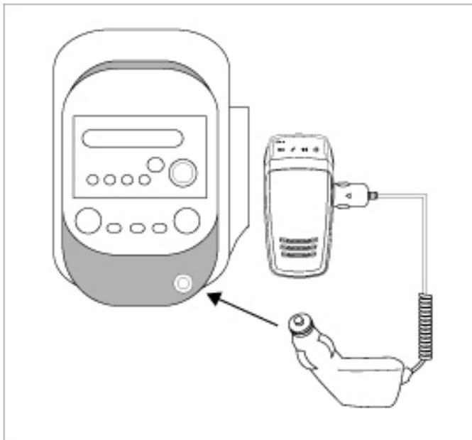
1. Inserte la punta de carga para automóvil en el enchufe de carga del vehículo.
