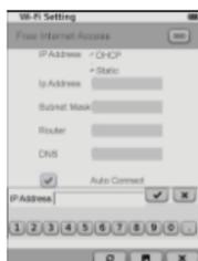
2. Sélectionner **Static** pour rechercher une adresse IP statique. Saisir les paramètres requis sur le clavier virtuel. Taper sur  pour confirmer la saisie.
