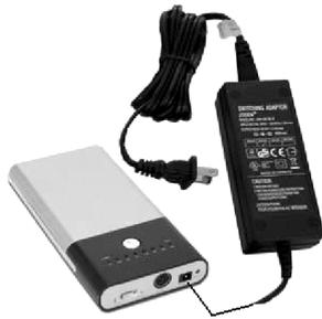
1. Schließen Sie den Ausgangskonnektor des Netzteils an den DC Eingang an.
