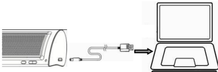
1. Conecte el altavoz al PC o al portátil con el cable USB suministrado. El indicador se enciende en azul cuando se establece la conexión.
