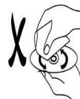
Ne pas essayer par un mouvement circulaire (les rayures concentriques à la surface du disque peuvent générer du bruit). Essuyer doucement le disque à partir du centre vers le bord externe (comme indiqué sur le schéma de droite).
