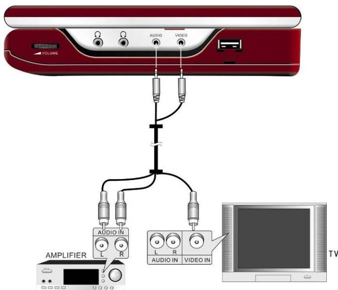
Suivre le schéma de gauche pour connecter le **PPDP 370 de Prestigio** à l'amplificateur via le câble audio/vidéo.
