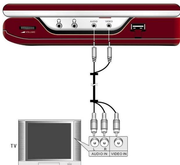
Suivre le schéma de gauche pour connecter le **PPDP 370 de Prestigio** à la TV via le câble audio/vidéo.
