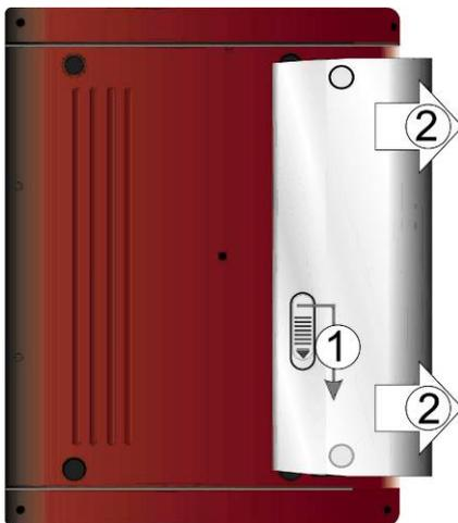
1. Presser et maintenir le bloc de batterie dans la direction  $\circ,1$  indiquée sur le schéma.
