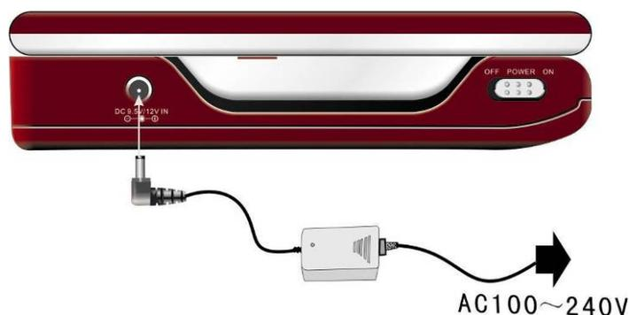
Suivre le schéma de gauche pour connecter le **PPDP 370 de Prestigio** à l'adaptateur CA.
