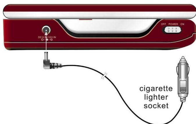
Suivre le schéma de gauche pour connecter le **PPDP 370 de Prestigio** à l'adaptateur CC de l'automobile alors que l'on allume l'appareil dans la voiture.
