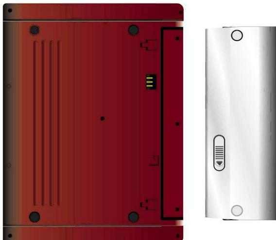
3. Retirer avec précautions le bloc de batterie de l'appareil.
