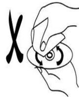
Ne pas essuyer par un mouvement circulaire (les rayures concentriques à la surface du disque peuvent générer du bruit). Essuyer doucement le disque à partir du centre vers le bord externe (comme indiqué sur le schéma de droite).
