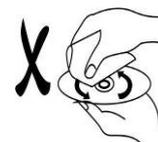
Não limpe num movimento circular (os riscos concêntricos na superfície do disco podem causar interferências). Limpe com cuidado a partir do centro do disco para extremidade exterior como indicado na figura da direita.
