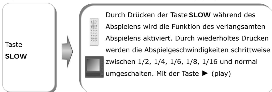
Durch Drücken der Taste **SLOW** während des Abspielens wird die Funktion des verlangsamten Abspielens aktiviert. Durch wiederholtes Drücken werden die Abspielgeschwindigkeiten schrittweise zwischen 1/2, 1/4, 1/6, 1/8, 1/16 und normal umgeschaltet. Mit der Taste ▶ (play)
