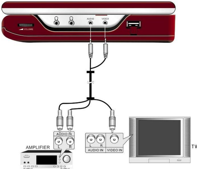
Den Anschluss des **Prestigio PPDP 585** an den Verstärker führen Sie mittels Kabel Audio/ Video laut Bild links durch.
