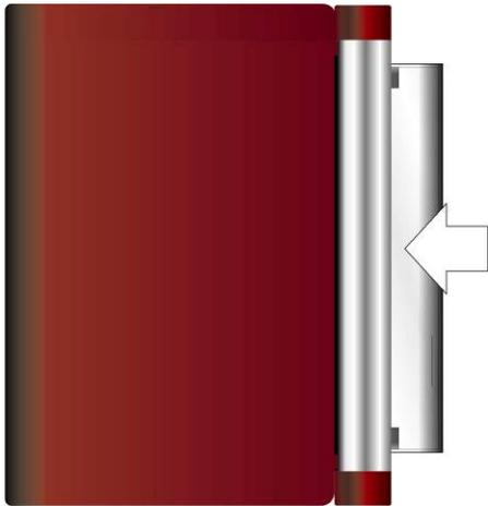
2. Durch leichten Druck in Pfeilrichtung schieben Sie den Modul laut Bild ein.
