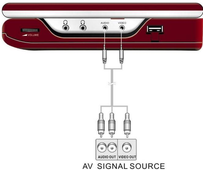
Den Anschluss des **Prestigio PPDP 585** an die anderen Geräte (den Quellen des AV Signals) führen Sie laut Bild durch. Dann stellen Sie mittels Taste AV IN/OUT den Modus AV/ IN ein.
