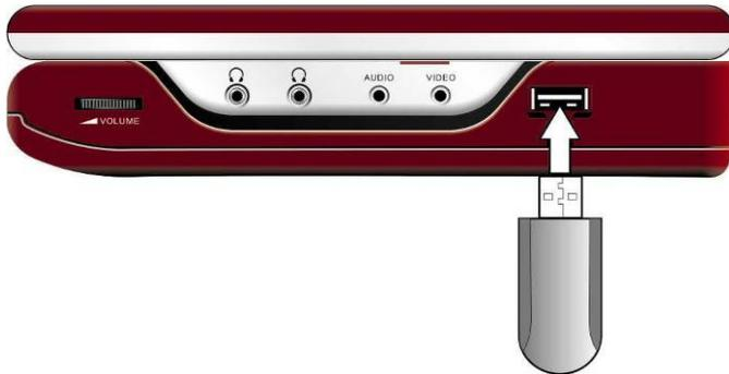
Den Anschluss des **Prestigio PPDP 585** an die USB Einrichtung führen Sie laut Bild links durch.
