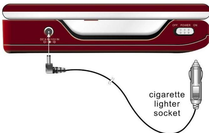
Den Anschluss des **Prestigio PPDP 585** im Auto mittels des DC Adapters führen Sie laut Bild links durch.
