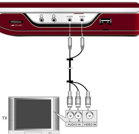
Den Anschluss des **Prestigio PPDP 585** an den TV führen Sie mittels des Kabels Audio/ Video laut Bild links durch.
