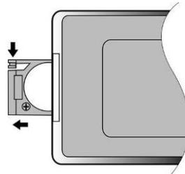
2. Legen Sie in den Halter eine neue Batterie vom Typ CR2025 3V ein (mit dem positiven Pol + übereinstimmend mit der Unterseite des Betätigers).
