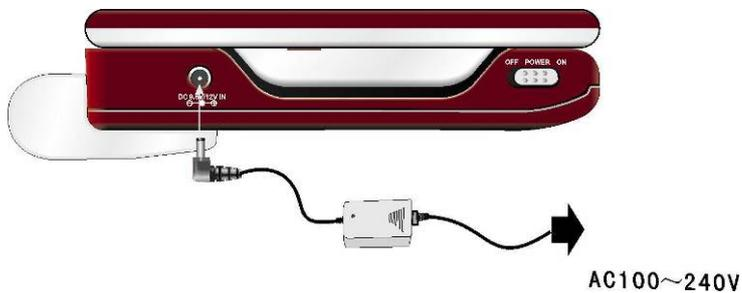
Suivre le schéma de gauche pour connecter le **PPDP 585 de Prestigio** au bloc de batterie pour le chargement.
