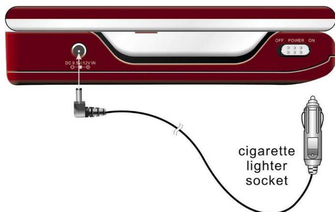
Suivre le schéma de gauche pour connecter le **PPDP 585 de Prestigio** à l'adaptateur CC de l'automobile alors que l'on allume l'appareil dans la voiture.
