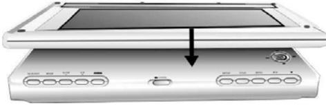
4. Beim Einlegen des Players in die Transporttasche, drehen Sie das LCD Panel um 180° in der Uhrzeigerrichtung und legen es auf das Bedienungspaneel. Das LCD Panel soll sorgfältig zusammengelegt werden, damit es in die Tasche passt.
