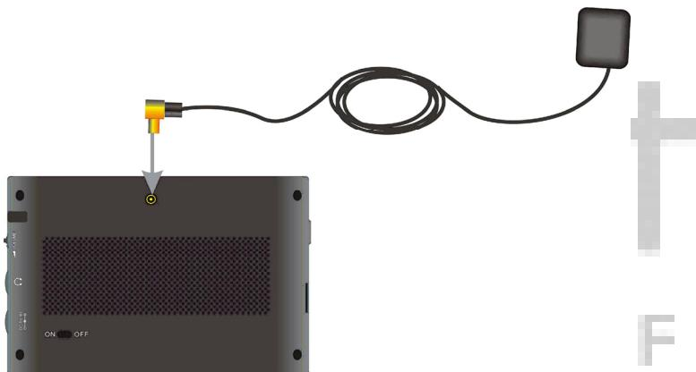
1. Uređaj je dizajniran za korištenje s GPS antenom koja se priključuje na uređaj radi ostvarivanja boljeg prijema signala.
