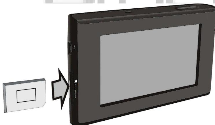
1. Stavite karticu memorije SD sa snimljenim fajlovima u utičnicu (samo da se uverite da pravilno stavite karticu).
