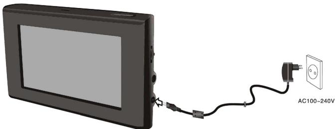
1. U kompletu napravi je mrežni adapter za napajanje naprave i punjenje munjosprema.
