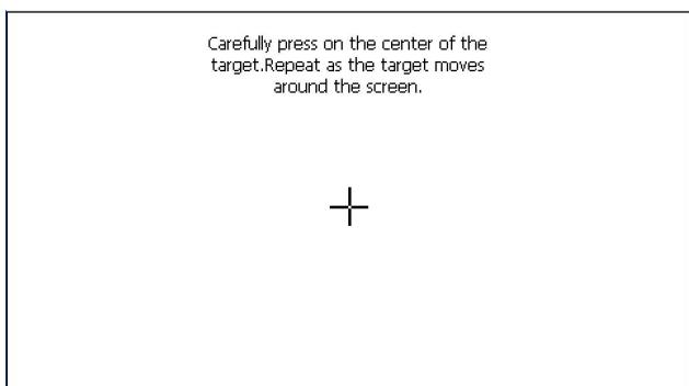
2. Vajutage risti ("+" ) keskmele seda ekraanil teisaldades. Varutage ristile vastavalt instruktsioonidele ekraanil. Teisaldamise tsükkeli: keskmes → ülemises vasakus nurgas → alumises vasakus nurgas → alumises paremas nurgas → ülemises paremas nurgas).
