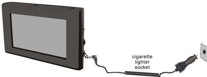
1. C'è adattore di auto per alimentazione del dispositivo e carica della batteria
