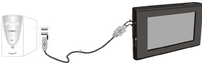
C'è anche USB slot in questo dispositivo per collegare al computer e per rinnovare le dati cartografiche. Seguire tutte le istruzioni:
