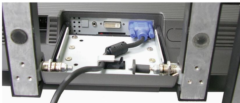
4. Audio kábel pripojte ku konektoru AUDIO-IN na monitore a jeho druhý koniec k linkovému výstupu na počítači.
