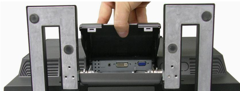
2. Na sprístupnenie všetkých prípojných portov otočte monitor dolu hlavou s panelom smerujúcim k vám.
