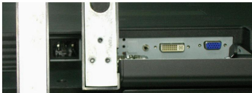
3. Signálny kábel pripojte ku konektoru VGA-IN na monitore a jeho druhý koniec pripojte k počítaču.
