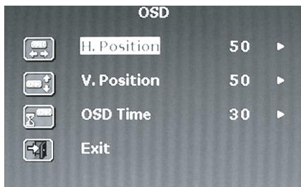
Na nastavenie horizontálnej pozície OSD menu použite tlačidlo  $\wedge$  alebo  $\vee$ .
