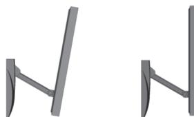
Вы можете крепить дисплей на стену с помощью нестандартного или стандартного (VESA) крепления. Отверстия под эти крепления расположены на обратной стороне опоры дисплея.
