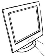
1. Tipka z apaljenje/gašenje monitora sa LED indikatorom
