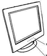
1. Stikalo za vklop in izklop z LED indikatorjem.
