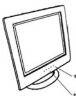
1. Vypínač a LED indikátor. 2. Funkčné tlačidlá
