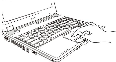
Сенсорная панель состоит из собственно панели, левой и правой кнопок и кнопки прокрутки. Для использования панели поместите свой указательный или большой палец на поверхность панели, которая служит в качестве миниатюрного отображения поверхности экрана. При перемещении пальца по панели происходит соответствующее перемещение курсора по экрану. Когда Ваш палец достиг края панели, приподнимите его и вновь поместите на противоположный край панели. Операции при работе с сенсорной панелью:
