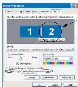
Нажмите на значке соответствующего монитора (например, (2)), чтобы расширить область рабочего стола на этот монитор.
