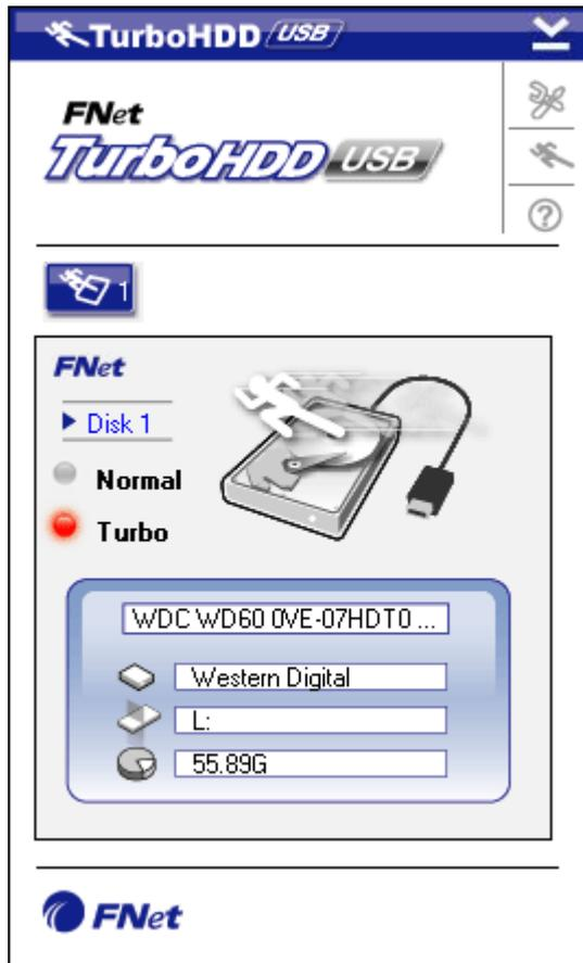
1. Klicken Sie auf dem Desktop auf den Shortcut "TurboHDD USB" oder auf Start Program Files → "TurboHDD USB" → "TurboHDD USB", um die Software zu starten.
