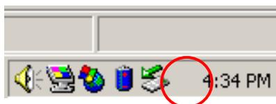
Dvoklikom na “safe removal” ikonu; “Unplug or Eject Hardware” prozor će se pojaviti. Na njemu izaberete uređaj koji želite iskopčati. Zatim, kliknite na [Stop] gumb. Nako toga, možete iskopčati uređaj iz USB port konektora na računalu.
