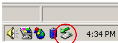
Произведите двойное нажатие левой кнопкой мыши по данной пиктограмме, на экране появится окно "Безопасное извлечение устройства" ("Unplug or Eject Hardware"). Выберите устройство, которое Вы хотите извлечь. Нажмите кнопку Остановить [Stop]. После этого Вы можете отключить устройство от порта USB.
