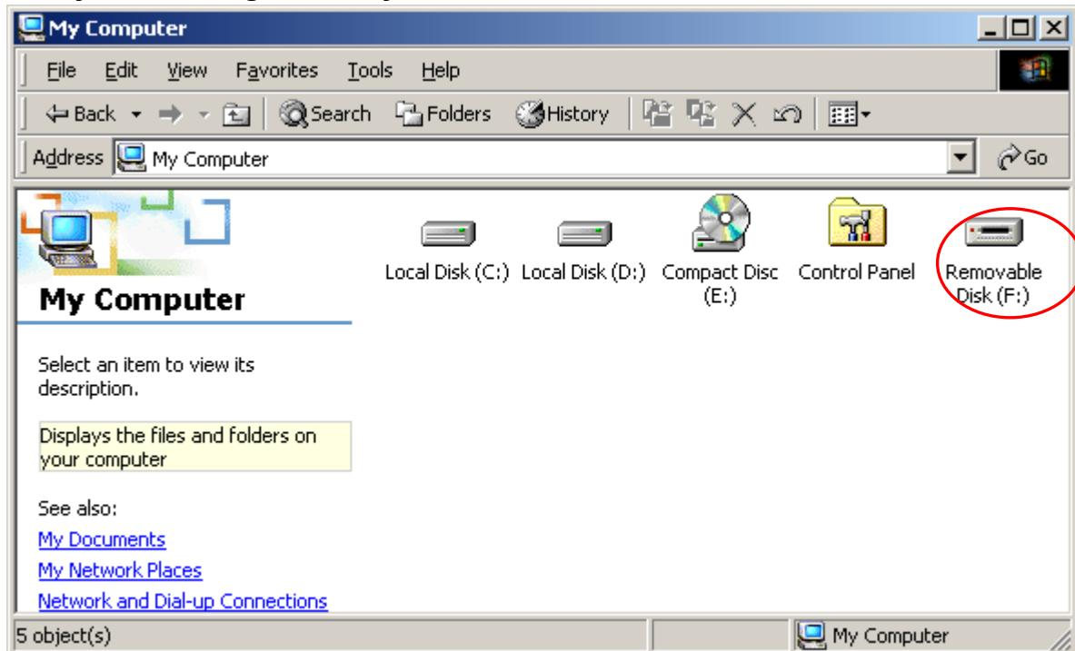
При подключении устройства к порту USB компьютера в папке Мой компьютер будет отображен значок Съемный диск ("Removable Disk"). В ОС **Macintosh** при подключении устройства к порту USB значок диска будет отображен на рабочем столе ("Desktop").
