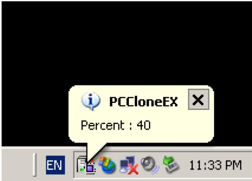
☞ Innerhalb des Prozesses der Sicherung, blinkt in der Menüleiste die Ikone des PCClone EX Programms. Wenn der Sicherungsprozess sich um 10% erhöht, erscheint ein Melde- Fenster.
